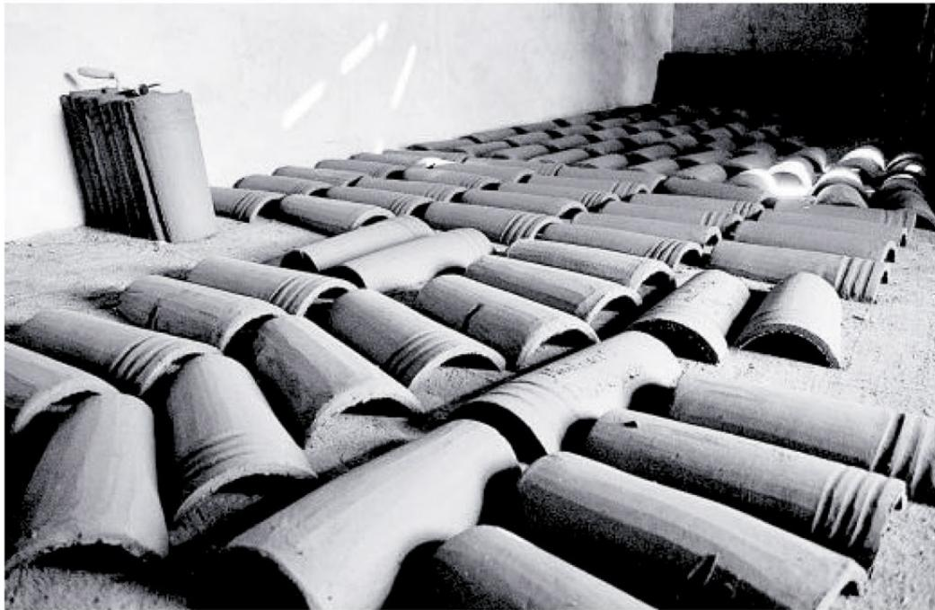
Las tejas crudas se guardan en un cuarto para que se vayan secando, si no, se partirían en el horno. | Y. MILLARES
