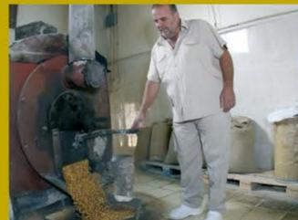
Después de unos 15 minutos, si es un tostado normal, el millo está en su punto y se extrae de la tostadora girando una simple palanca.
