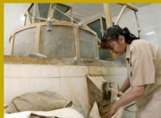
Después de reavivarle la aspereza, en una hora da 45 kilos de gofio de mejor calidad que con piedra importada (150-200 kilos/hora).
