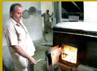
A la tostadora llega el millo limpio. Antigamente con sistema de cocinillas de fuelle, ahora funciona con un quemador de horno.
