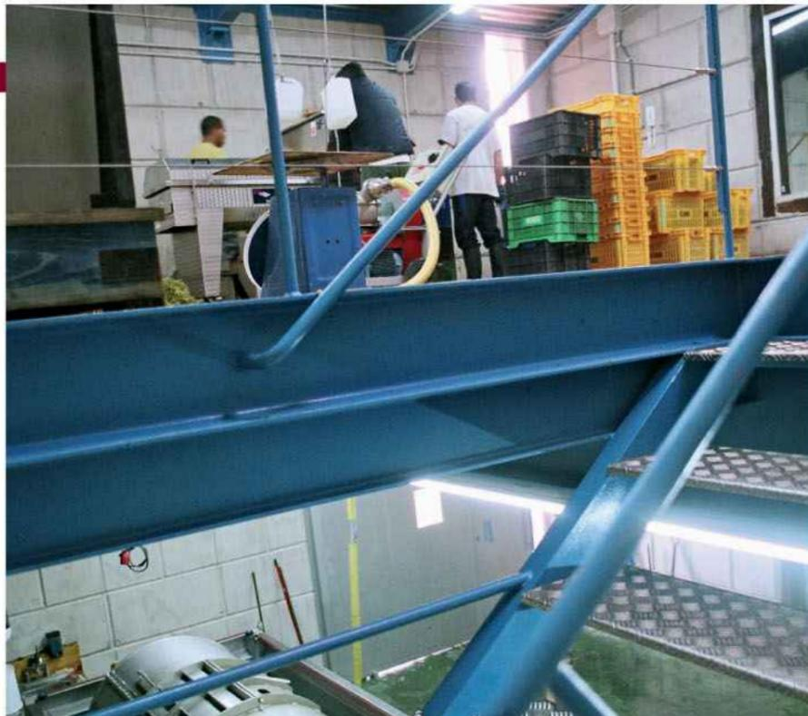
Recepción por gravedad de la uva: las cajas de vendimia se descargan sobre la tolva de la despalilladora (planta superior) y la uva baja directamente a la prensa (planta inferior)./ Y.M.
