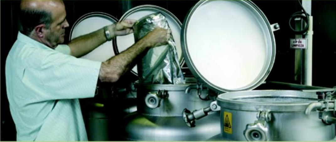
Un operario de la fábrica de Dorada añade lúpulo junto al whirlpool (tanque de centrifugado del agua y la malta)./ L. P. (CCC)
