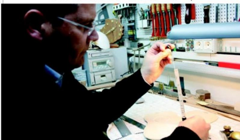
Calibrando el grosor de la tapa armónica./ Y.M.
